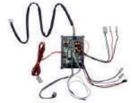
Circuito + cables antihumedad
